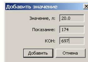
Тарифовка заключается в постепенном сливе или заливке топлива в бак от минимума до максимума с определенным шагом и занесении в таблицу показания датчика для каждого значения объема топлива. Шаг проливки может составлять от 5 до 20 литров в зависимости от емкости бака. Чем точнее будет пролит бак, тем меньше погрешностей будет при дальнейших измерениях. Рекомендуется делать не менее двадцати точек тарифовки в таблице.
