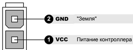
Через этот разъем обеспечивается питание контроллера. Диапазон питающего постоянного напряжения от +8 до +32 В. Средняя потребляемая мощность около 1,4 Вт, но в режиме передачи могут быть пики потребления до 4-5 Вт.
