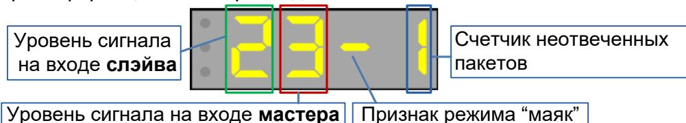
При отправке каждого очередного тестового пакета счетчик неотвеченных пакетов увеличивается на 1, а при получении ответа от удаленного модема — сбрасывается в 0. Отображение этого счетчика на индикаторе производится на короткое время в момент передачи тестового пакета.
