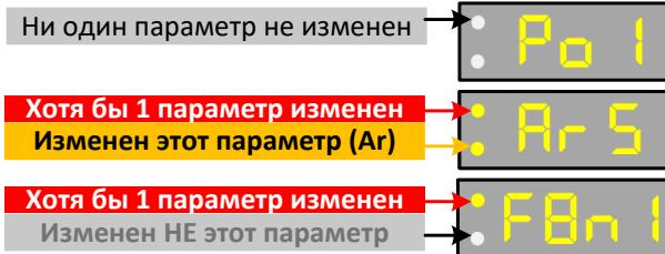
Для выхода из режима конфигурации необходимо нажать **EXIT** **длинное**. При этом если ни один из параметров не был изменен, модем просто выйдет в рабочий режим. Если же был изменен хотя бы 1 параметр, при выходе из конфигурации модем будет перезагружен для сохранения параметров.
