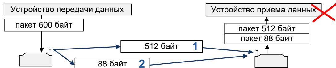
Модуль не может передать все 600 байт одним пакетом. Он разбивает его на части и каждую часть маркирует специальными маркерами. Приемный модуль, при активации данной функции может их конкатенировать (объединить) в один пакет и выдать в порт единым целым.
