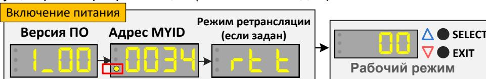
Сразу после этого модем автоматически переходит в рабочий режим и на индикаторе отображается экран рабочего режима (или в режим "маяк", если активен).
