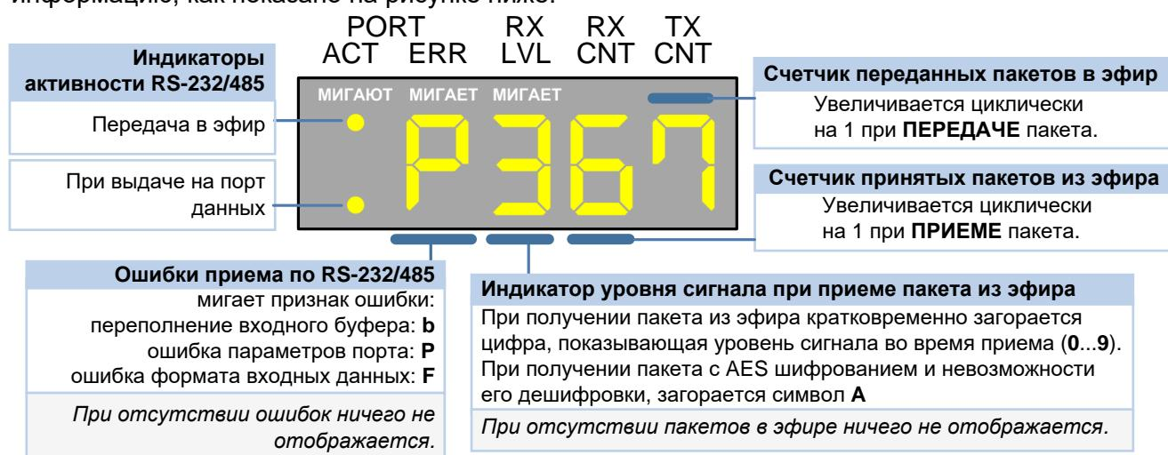
В случае обнаружения ошибки при приеме данных по порту, символ индикатора PORT ERR начинает отображать **мигающий** символ, в зависимости от типа ошибки:
