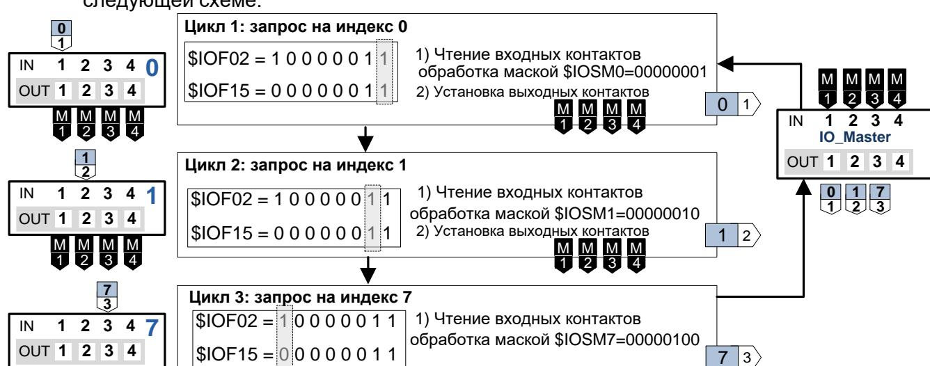
Таким образом, полный цикл работы модуля IO\_Master будет состоять из 5 команд.
