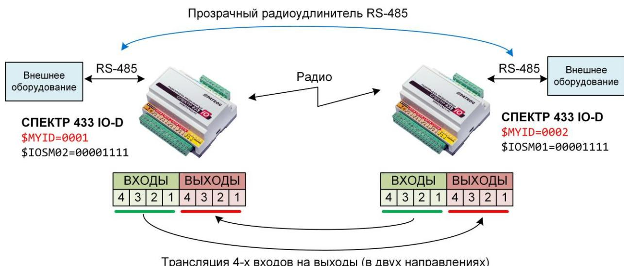
В случае применения двух радиомодулей достаточно обеспечить трансляцию всех четырех входов одного модуля на все четыре выхода второго и наоборот.
