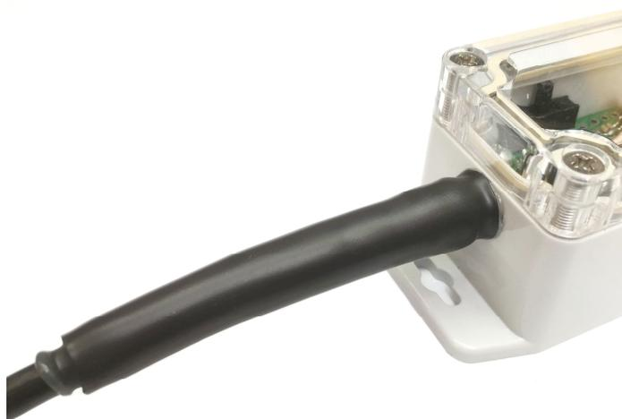
Термоусадочная трубка подходит для герметизации разъемов и кабелей с небольшим отличием в диаметре, как в случае кабеля RG-58 и разъема SMA у модема. Если же необходимо герметизировать кабель с разъемом, чьи диаметры сильно отличаются (например, тот же кабель RG-58 и разъем TNC и N-типа, часто используемый на антеннах) термоусадка уже не подойдет.
