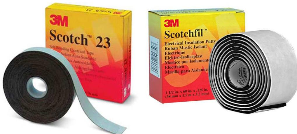
Для герметизации следует плотно, с натяжением при намотке и перекрытием витком намотать электроизоляционную мастику или самовулканизирующуюся клейкую ленту на разъемное соединение (начиная с антенного кабеля и до самого корпуса модема). Намотку осуществить в одном и, не прерываясь, в другом направлении.
