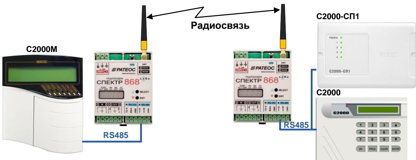
В качестве ведущего устройства (Master) выступает пульт C2000M. В качестве ведомых устройств (Slave) - C2000-СП1 и C2000.
